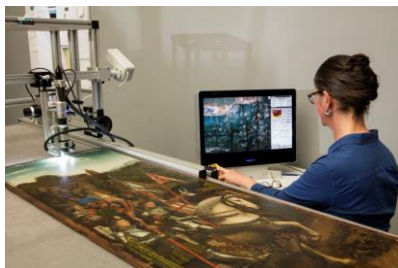
Examen sous le microscope numérique 3D de l'université de Gand Credit line = © KIK-IRPA, Bruxelles
